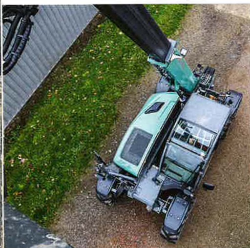
Bei ganz angehobenem Arm erreicht die Maschine 6,17 m Hubhöhe. Der Fahrer muss sich für gute Sicht etwas nach vorn beugen.
