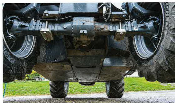
Der Unterboden ist geschlossen, die Vorderachse mit einer 100%-Differenzialsperre ausgestattet.
