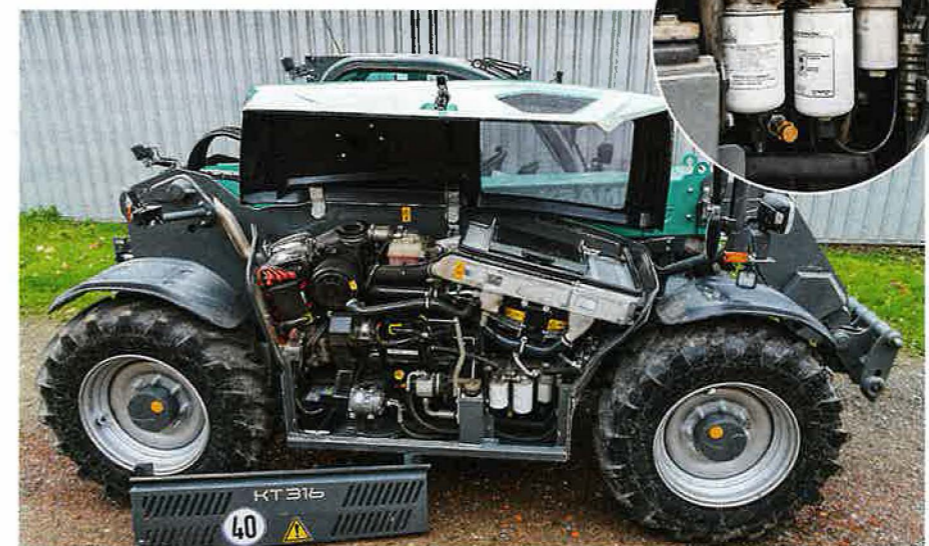
Kramer setzt auf einen Deutz-Motor mit liegendem Kühlerpaket. Sehr gut ist die zentrale Anordnung der Filter.
