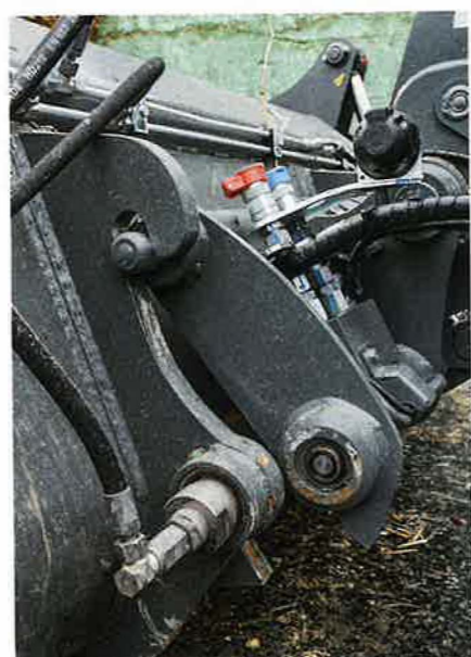
Mit dem SmartAttach-System werden die Hydraulik-Verbindungen für das Anbaugerät automatisch gekoppelt.
