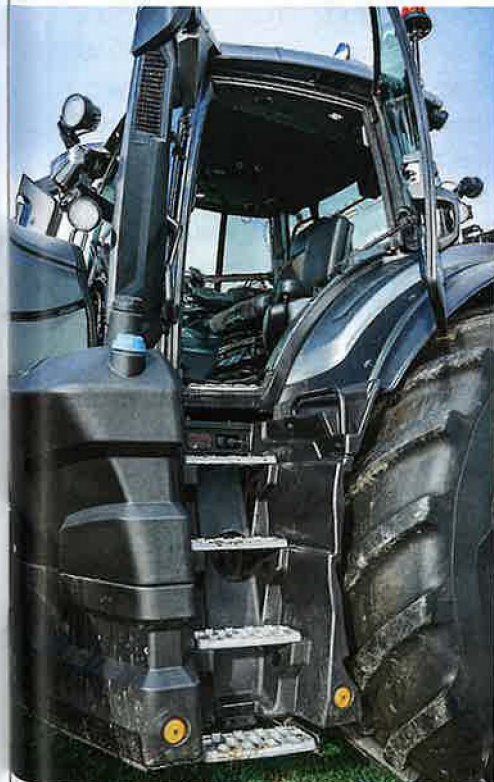
Der Aufstieg ist schön geräumig und griffig. Der Türgriff ist innen zu niedrig.
