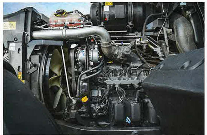
8,4 l Hubraum und eine gute Motor-Getriebe-Abstimmung, aber ein viel zu lauter Lüfter. Und für den Luftfilter braucht man lange Arme.
