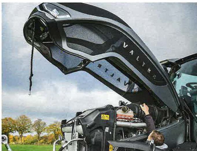
8,4 l Hubraum und eine gute Motor-Getriebe-Abstimmung, aber ein viel zu lauter Lüfter. Und für den Luftfilter braucht man lange Arme.
